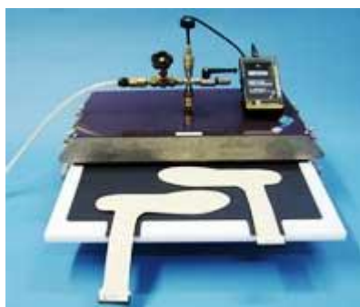
Obrázek č. 13 - Kalibrační zařízení Trublu s tenzometrickými stélkami Pedar-X
