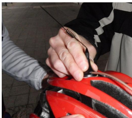
Obrázek č. 17 - Připevnění antény na helmě pro vysílání Bluetooth
